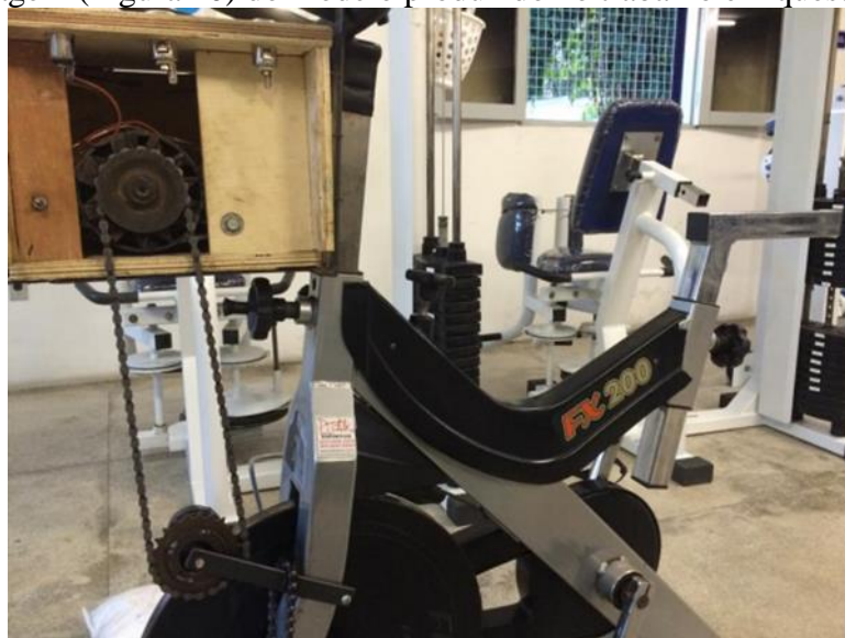
Figura 20 - Sistema adaptado para a captação de energia utilizado no artigo. Fonte: SILVA, Jeisiane, 2015, pág 40).
