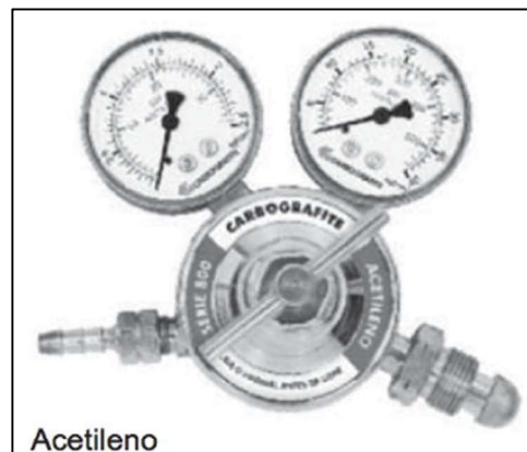
Figura 5 - Regulador de pressão para acetileno para cortes até 300mm
