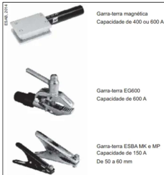
Figura 9 - Garra ou grampo terra
