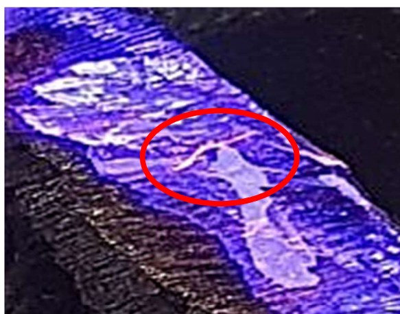
Figura 29 - Trinca revelada por ensaio de partículas magnéticas fluorescentes
