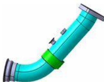
Figura 22 — Tubo primário dos motores de (190 Cv) EURO5.
