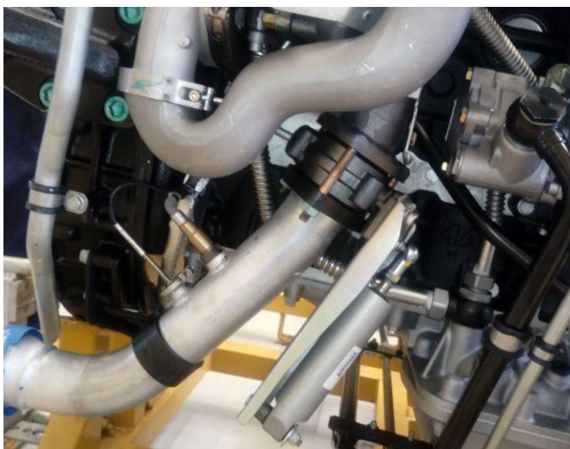
Figura 25 — Try out efetuado na linha de produção com o tubo primário dos motores (190 Cv) no motor de (230 Cv).
