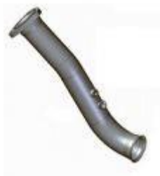
Figura 13 — Tubo Primário de um sistema de exaustão de um motor EURO5
