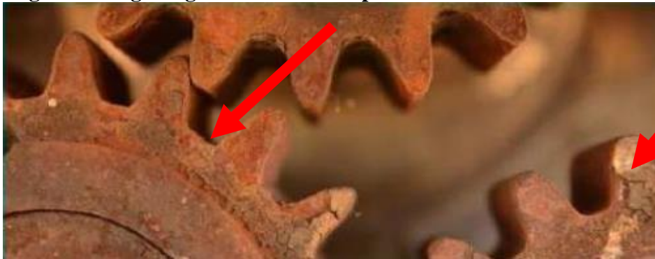
Figura 9- Engrenagens metálicas em processo de corrosão uniforme
