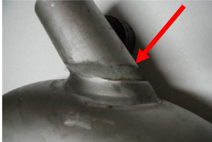
Figura 8– Resultado da corrosão intergranular
