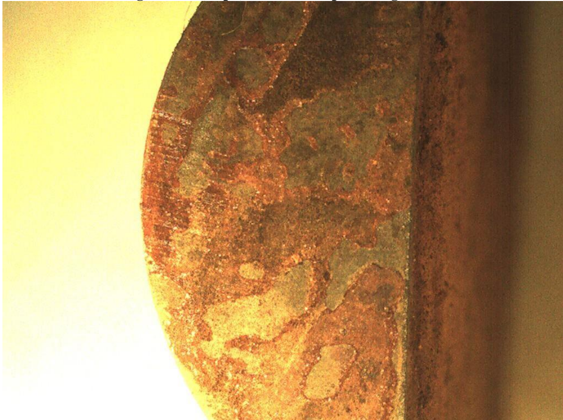
Figura 22 - (Topo) Amostras exposta a água doce
