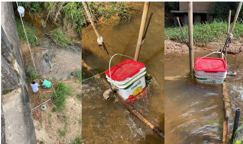
Figura 40 - Sistema de tubulação e montagem do sensor de fluxo no rio
