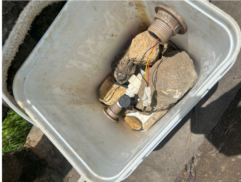
Figura 39 - Montagem do sensor de fluxo em um balde com vedação
