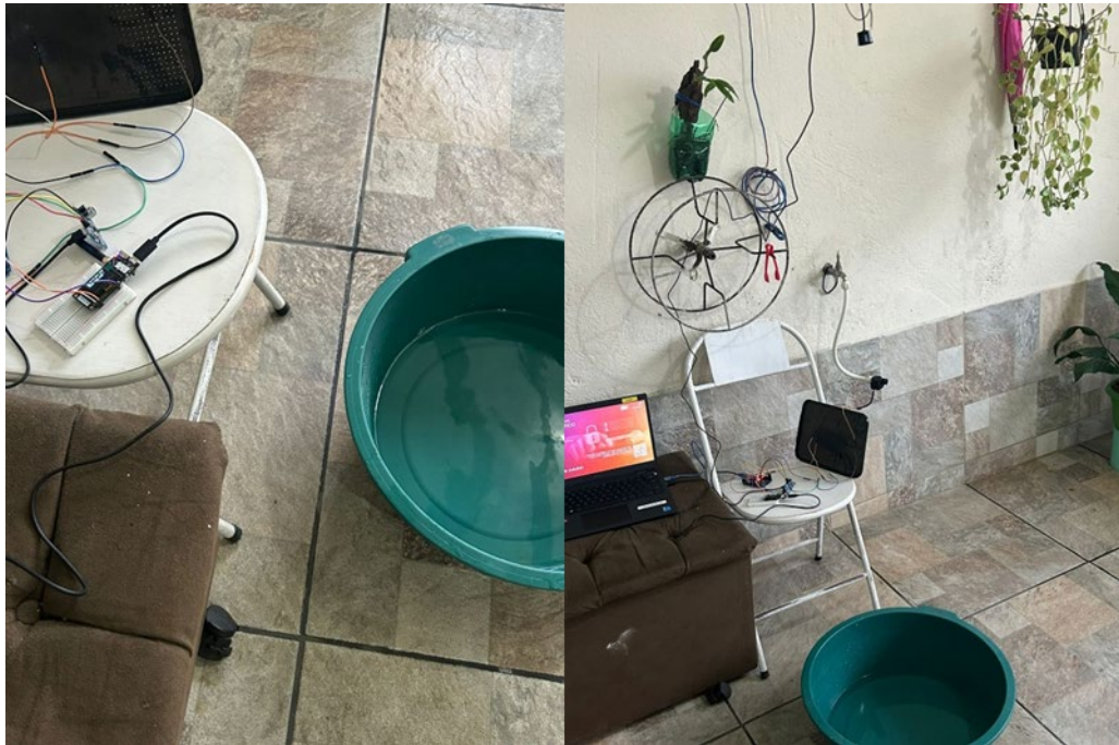
Figura 52: Teste de Sensibilidade do Sensor de Nível com 2 cm de Água na Bacia
