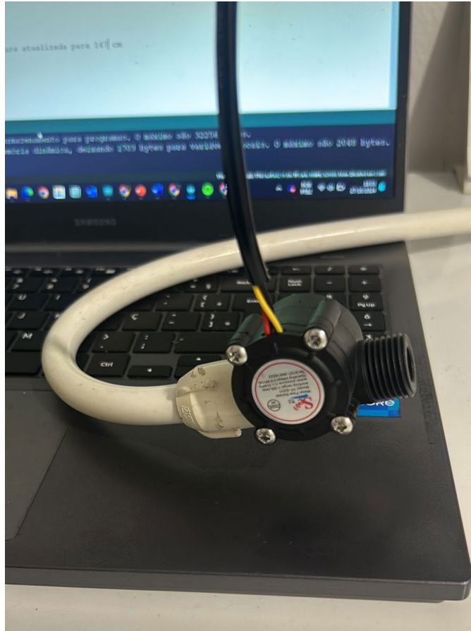
Figura 30: Teste do Sensor de Fluxo de Água YF-S201 com Mangueira para Simulação de Taxas de Fluxo
