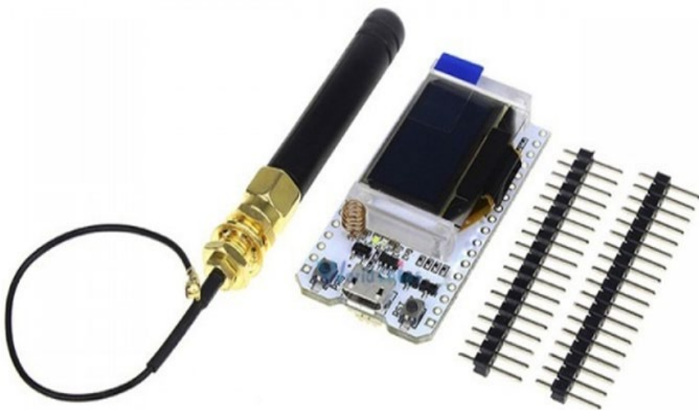
Figura 11: Módulo LoRa com Antena e Pinos de Conexão para Monitoramento Remoto
