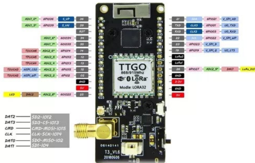
Figura 32: Esquema de Pinagem do Módulo LoRa ESP32 TTGO LILYGO T3 com Funções ADC, GPIO, I2C e SPI
