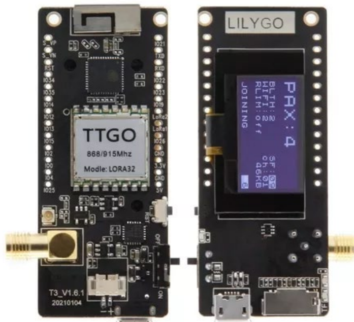
Figura 31: Módulo LoRa ESP32 TTGO LILYGO T3 V1.6.1 Pax Counter com Display OLED para Monitoramento em Tempo Real
