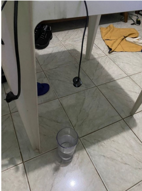
Figura 26: Configuração de Teste do Sensor de Nível Ultrassônico com Recipiente de Água
