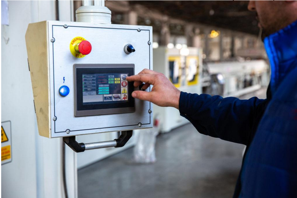
Figura 3 - Interação de um operador com uma IHM em um processo produtivo
