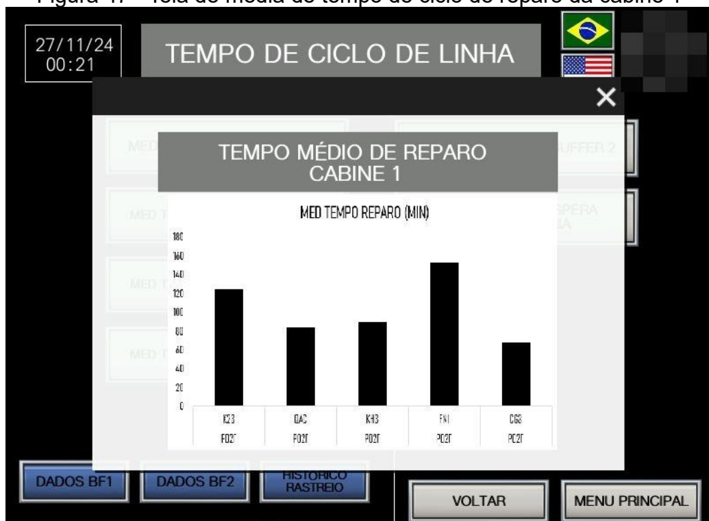
Figura 47 - Tela de média de tempo de ciclo de reparo da cabine 1
