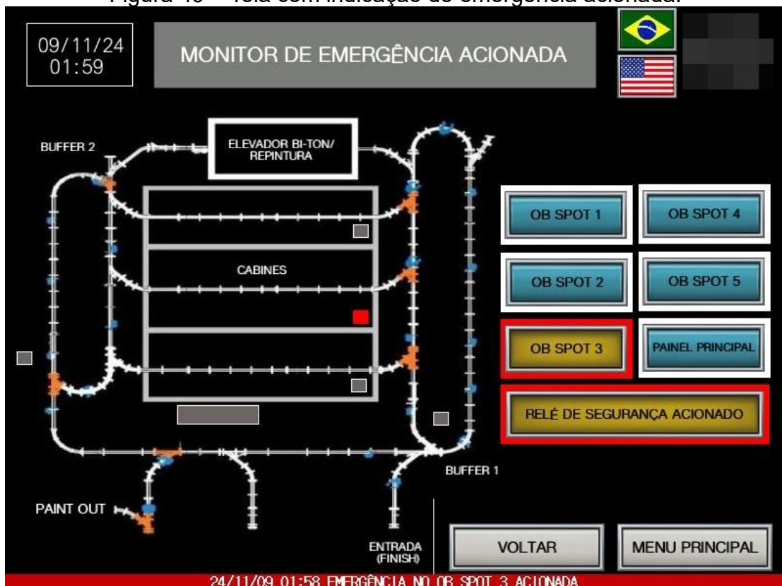
Figura 49 – Tela com indicação de emergência acionada.
