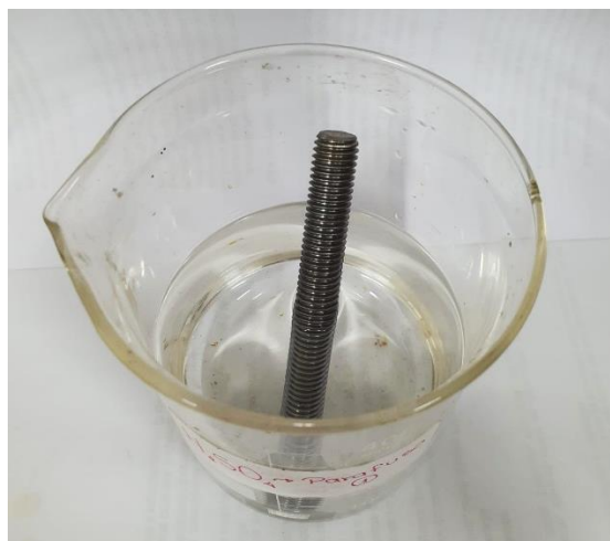
Figura 20 Corrosão do aço inoxidável
