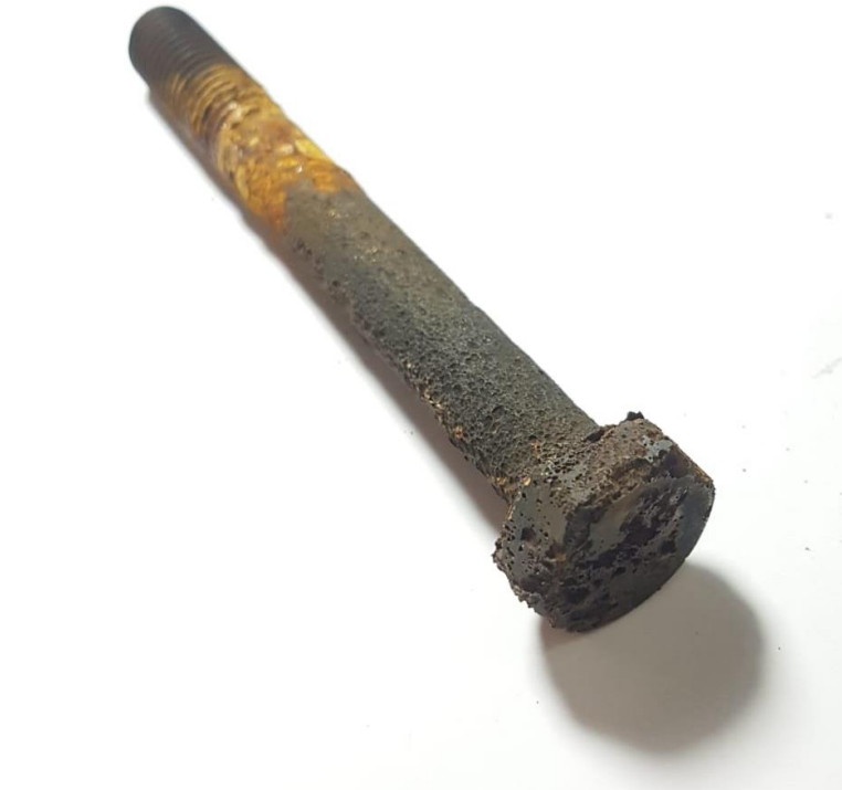
Figura 22 Corpo do parafuso 1 após teste de corrosão
