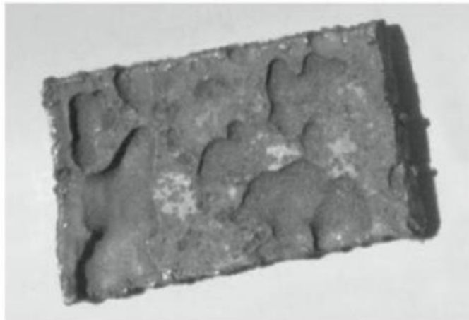
Figura 2 Corrosão por placa
