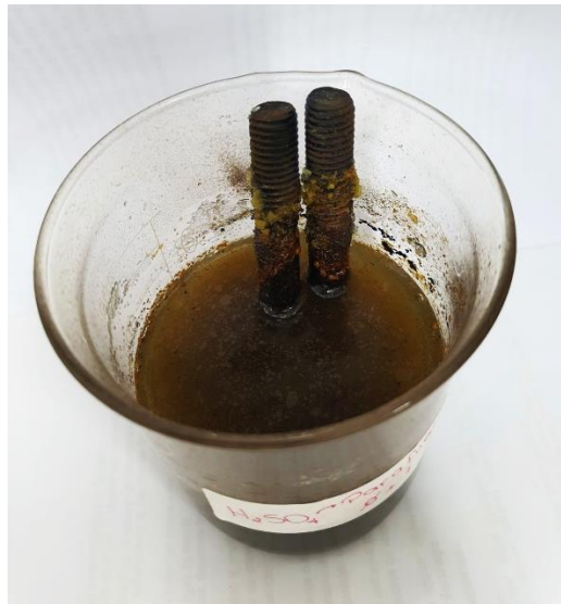
Figura 19 Corrosão do aço carbono
