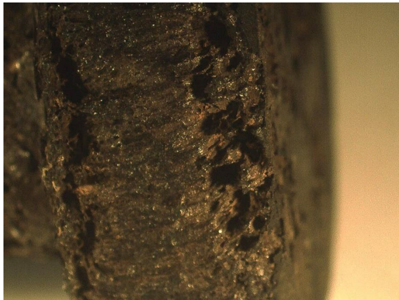
Figura 25 Corrosão na cabeça do parafuso 1 de aço carbono
