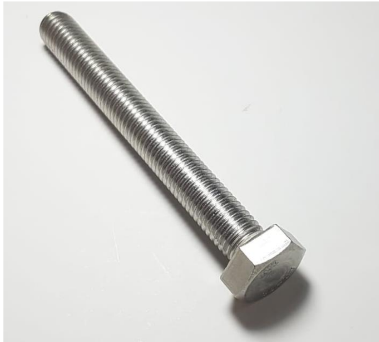
Figura 30 Aço inoxidável após teste de corrosão
