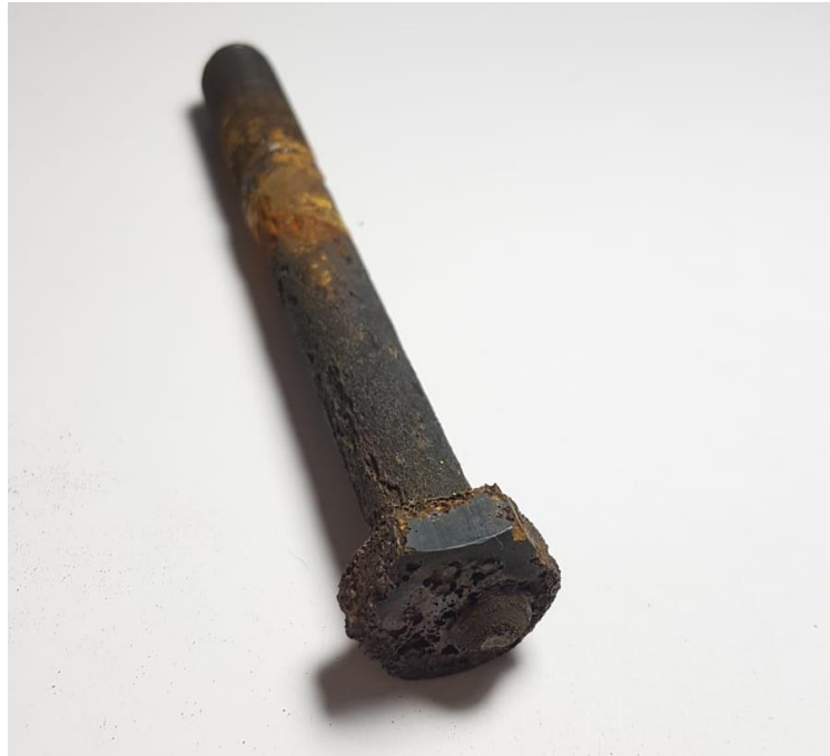
Figura 26 Corpo do parafuso 2 após os testes de corrosão
