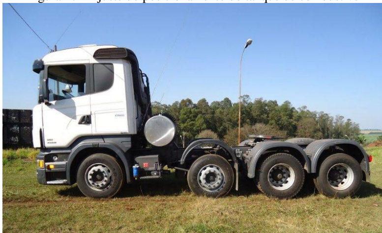
Figura 27 - Ajuste do posicionamento do tanque de combustível
