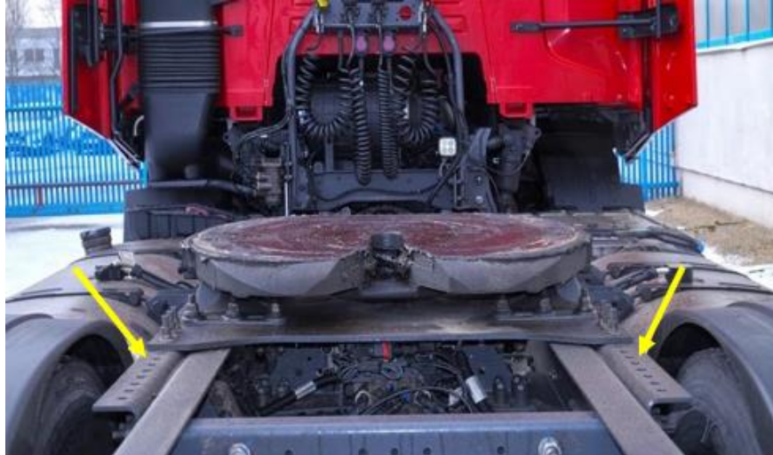
Figura 28 - Regulagem do posicionamento da 5ª roda
