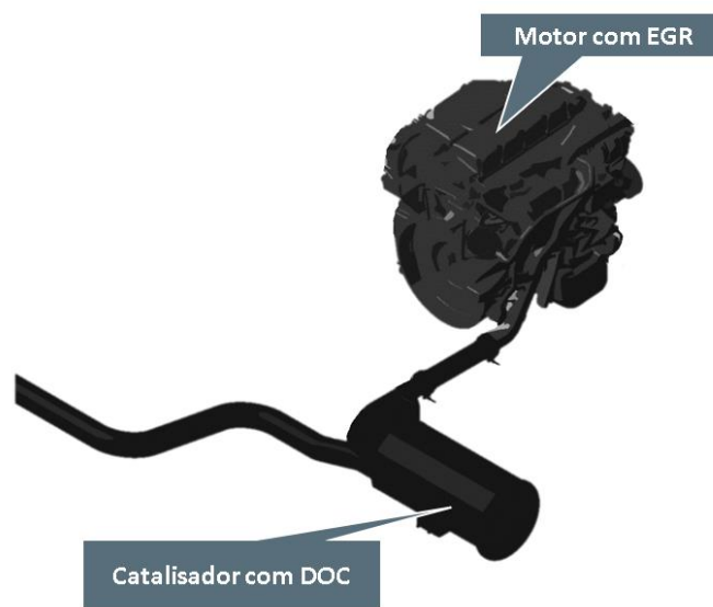
Figura 15 - Sistema de exaustão de um veículo pesado sob a norma PROCONVE P-7.
