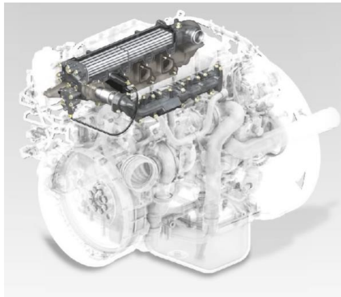
Figura 10 - EGR em destaque em um motor de caminhão.
