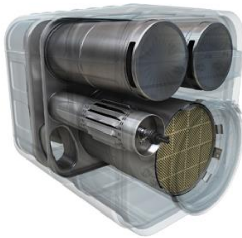
Figura 21 - Catalisador com DOC, DPF e SCR dentro de uma mesma geometria.
